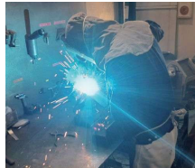
▲半自動溶接作業
